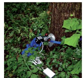
Fig. 4 Inclinometro con trasmettente Bluetooth
