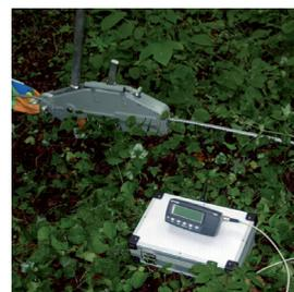
Fig. 3 Paranco e unità di raccolta dati dal dinamometro
